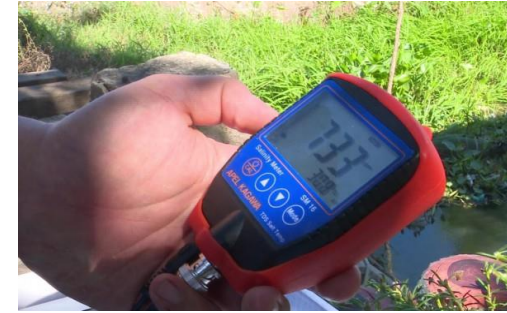
Hình 4: Kiểm tra độ mặn trước khi bơm nước vào ruộng.
